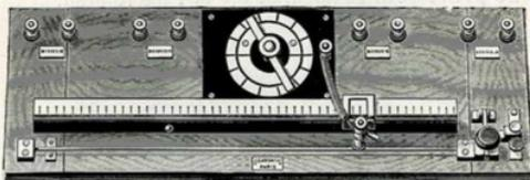
**Ohmmètre portable,** pour la mesure des isoléments.
